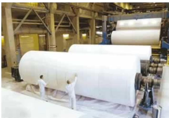
Depois de enrolado, o papel passa por bobinas que irão cortá-lo seguindo padrões de tamanho e gramatura. Depois, as máquinas empacotadoras separam a quantidade de folhas em cada pacote, e colocam cada pacote em caixas.
